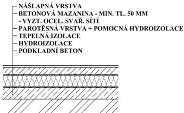
Obr. 1: Princip obvyklé skladby podlah situovaných na terénu
